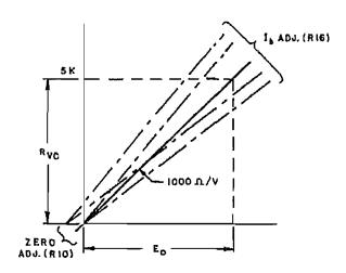
FIG. 3-6 ESTABLISHING PROGRAMMING LINEARITY.
