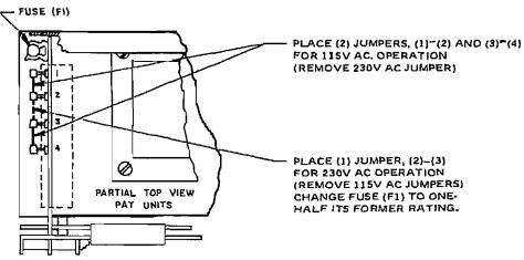
FIG. 2-2 CONVERSION TO 230V A-C OPERATION.
